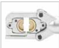
Crimp copper lug 16-300mm 2 or aluminum lug 10-240mm 2
